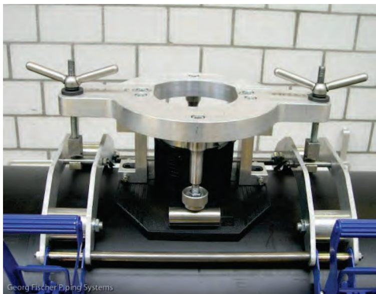
Fot. 9. Przyrząd do dociskania obejm do powierzchni rury
