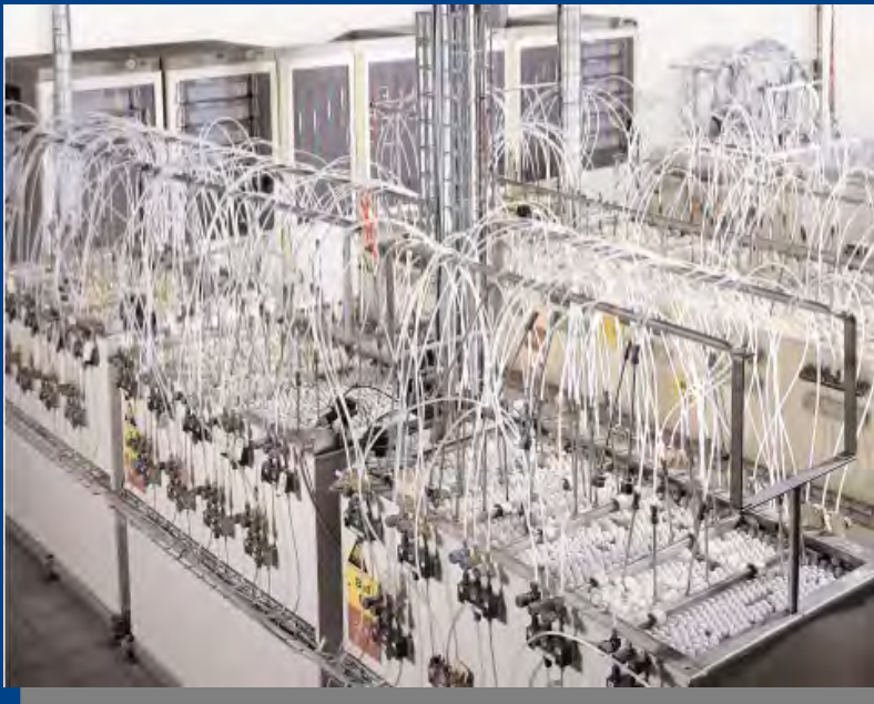
Platforma testowa do badania odporności na pełzanie
