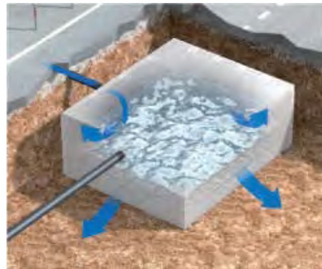
Infiltracja do gruntu
