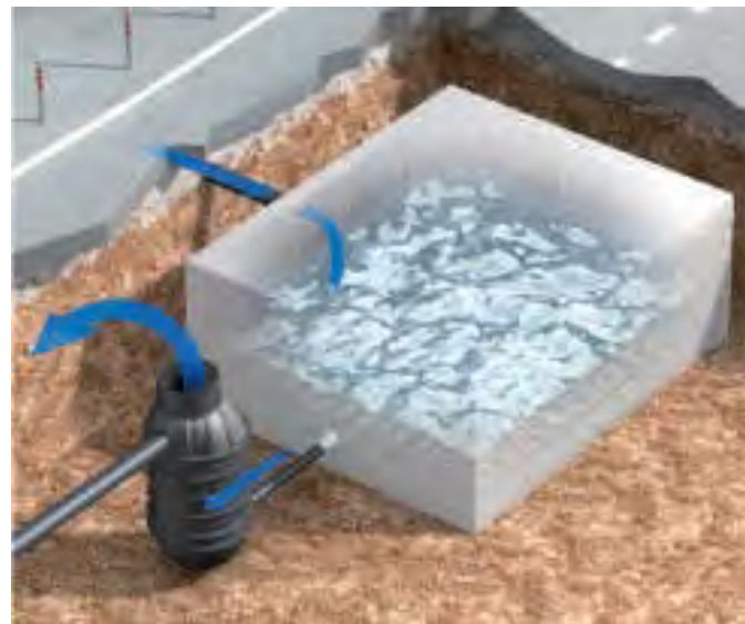
Magazynowanie i powtórne wykorzystanie wody deszczowej
