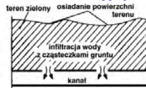
Osiadanie powierzchni terenu nieutwardzonego nad miejscem ułożenia uszkodzonego kanału
