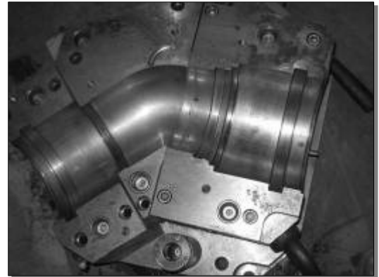
Fot. 10. Wtryskarka i przykładowa forma do produkcji kształtek z tworzyw sztucznych.
