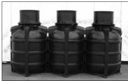
Fot. 13. Przykład formy i wyrobu powstałego w procesie wtrysku rotacyjnego.
