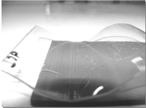
Wygląd zgrzewu wykonanego metodą termiczną:
